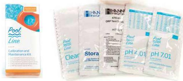
**BL123-70** Kit Pool Line de mantenimiento y calibración de electrodos, 5 bolsas de 20 ml: 1 de pH 7.01, 1 de pH 4.01, 1 de REDOX 470 mV, 1 de limpieza y 1 de almacenamiento.
